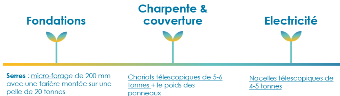
Figure7 : Les différentes étapes de la phase chantier d'une installation agrivoltaïque chez Technique solaire
